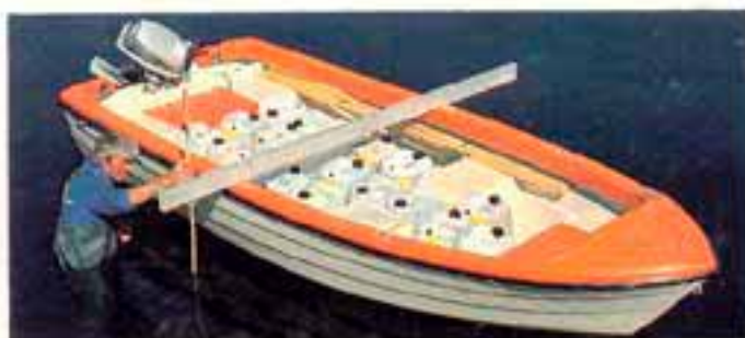
Fribordsmätning med belastning
