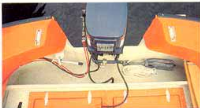
Stor motorbrunn med skvalpskott
