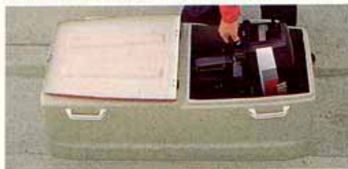
"Långbänken" är konstruerad som ett stort låsbart forutrymme till fiskesump med en volym på hela 220 l där t.o.m. en hjälpmotor får plats. Fungerar dessutom utmärkt som sitt- och arbetsbänk.
