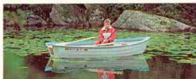
Den mjukt formade relingen styrar upp hela båtkonstruktionen och ger båtarna ett elegant utseende.
