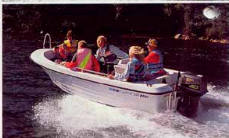
Bilderna visar en babordsmonterad extramotor.
