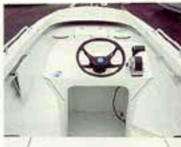
Celest centralstyrpulpit Passar till båtar med plan deck och med inv. bredd mellan relingsargen på ca 150 cm eller mer för acceptabelt passagerutrymme runt pulpiten. Rejäl lack och utrymme för instrument och toppreglage. Färg: vit. Max bredd 78 cm. Däckbredd 59 cm. Djup 53 cm. Max höjd 85 cm – kapas till lämplig höjd. Vikt ca 13 kg. Rostfritt grabbräcke passar till Crescentmodellerna: 550, 504, 498, 465, 434 och 410. Grabbräcket passar även till båtar av annat fabrikat. Längd 168 cm. Höjd 10 cm.
