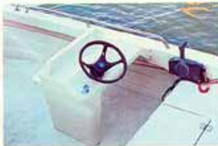
Pulpit för säker omborstigning Fästöglan i framkanten hindrar tampen att glida upp vid förtöjning. Höjd 45 cm. Bredd 34 cm. Vikt ca 1 kg.
