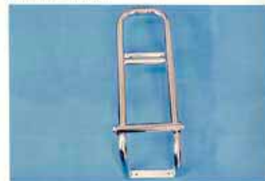
Rustfri bad- och räddningssteg. Passar till de flesta båtar. Längd, nedfölld 70 cm, uppfölld 50 cm. Bredd 18 cm. Ø 25 mm. Materialtjocklek 1,5 mm. Artikelnr: 700 700 200.
