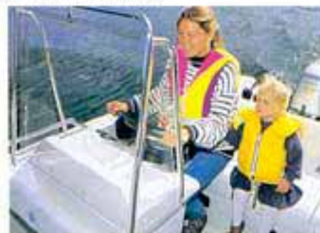
Vindskärm till Celest sidostyrpulpit av Lexan polykarbonat med rostfritt handtag runt om. Höjd 70 cm. Artikelnr: 800 200 600.
