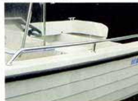
Rostfritt grotbrücke. Längd: 170 cm. Höjd: 10 cm. Ø: 25 mm. Materialtjocklek: 1,5 mm. Artikelnr: 700 700 200
