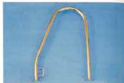
Rustfri pulpit för säker ombordstigning. Fastöglan i framkanten hindrar tampen från att glida upp vid förtöjning. Höjd 45 cm. Bredd 34 cm. Ø 25 mm. Materialtjocklek 1,5 mm. Artikelnr: 876 460 310.
