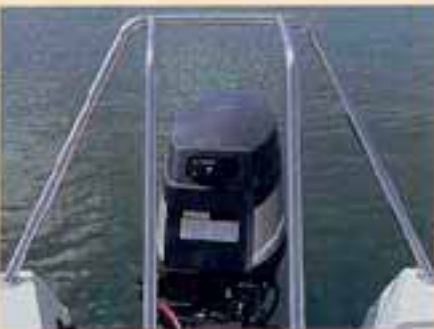
"Snöbåge", en praktisk akterpulpst, som ger bra greppmöjligheter runt om motorbrunnen. Finns i två storlekar - 80 cm till smal motorbrunn, 100 cm till bred. Maxhöjd: 47 cm. Ø: 25 mm. Materialtycklek: 1,5 mm. Artikelnr: 80 cm 877 425 490, 100 cm 877 425 491.
