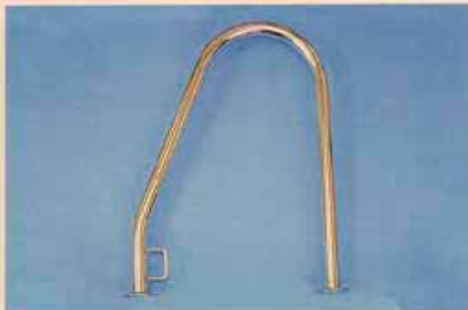
Rostfri pulpit för säker ombordstigning. Fästoglan i framkanten binder tampen från att glida upp vid förtöjning. Höjd: 45 cm. Bredd: 34 cm. Ø: 25 mm. Materialtjocklek: 1,5 mm. Artikelnr: 876 460 310.
