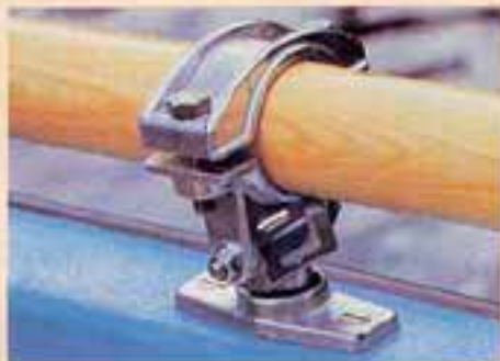
Exklusiv arklykta. Med denna arklyktakonstruktion kläms årorna fast i önskat läge. Elimineras försvagning av åren vid borrning med genomgående sprit. Arklyktan passar till de flesta båtar. Artikelnr: 760 761 830.
