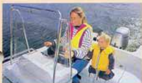
Vindskärm till Celest sidostyrpulpst av Lexan polykarbonat med rostfritt handtag runt om. Höjd: 70 cm. Artikelnr: 800 200 000.
