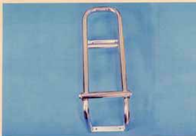
Rostfri bad- och räddningsstige. Passar till de flesta båtar. Längd, nedfäld: 70 cm. uppfäld: 50 cm. Bredd: 18 cm. Ø: 25 mm. Materialtjocklek: 1,5 mm. Artikelnr: 700 700 200.
