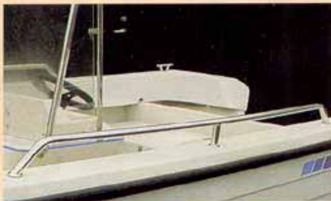
Rostfritt grabbräcke. Längd: 170 cm. Höjd: 10 cm. Ø: 25 mm. Materialtjocklek: 1,5 mm. Artikelnr: 700 700 200.
