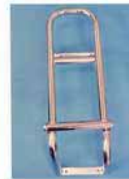
Båd- och räddningsvege, rostfri. Ø 25 mm. Bredd 18 cm. Materialtjocklek 1,5 mm. Längd nedfäld 70 cm, uppfäld 50 cm.
