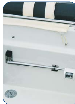
Fällbar lanternstång med akter-lanterna, komplett med kabel. Höjd 47 cm. Materialtjocklek 1,5 mm.
