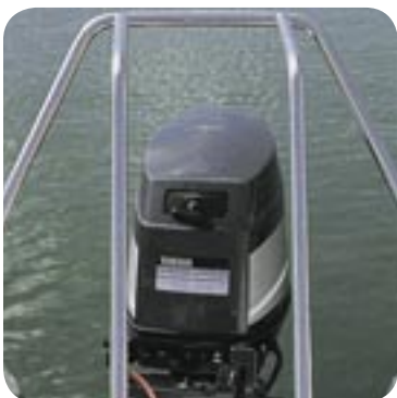
"Snoobbåge" , en praktisk akterpulpit, som ger bra greppmöjligheter runtom motorbrunnen. Finns i två bredder. Ø 25 mm. Materialtjocklek 1,5 mm.
