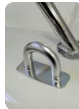
Rostfri läsögla, godkänd av SSF klass 3. Försvårar stöld av låst båt. Materialtjocklek 14 mm.
