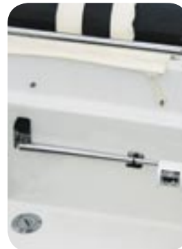
Fällbar lanternstäng med akter-lanterna, komplett med kabel. Höjd 47 cm. Materialtjocklek 1,5 mm.
