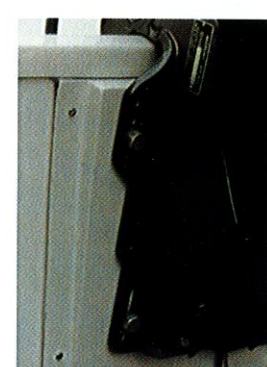
Vinklad motorplatta av glasfiber. För maximalt utnyttjande av motorer med Power Trim. Höjd 37 cm. Bredd 41 cm. Största tjocklek 2,5 cm.
